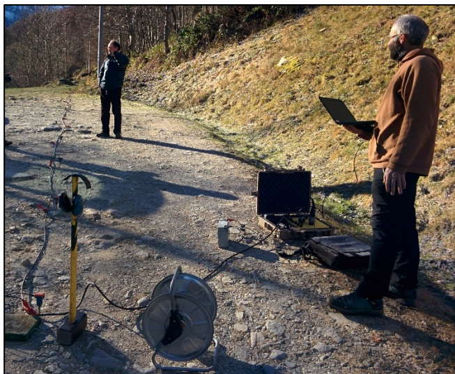
Figura 3 – Strumentazione utilizzata – Sismografo Daq Link IV
